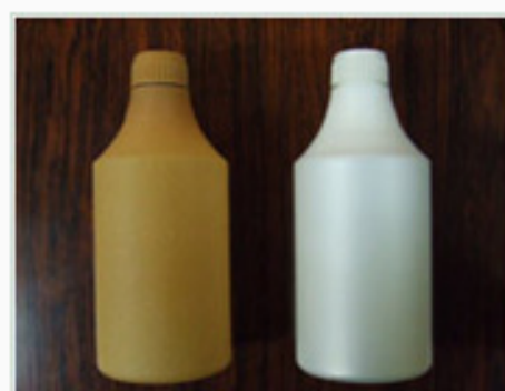
古古米ベースのバイオプラスチック(左)とポリ乳酸プラスチック(右)のブロー成形サンプル
